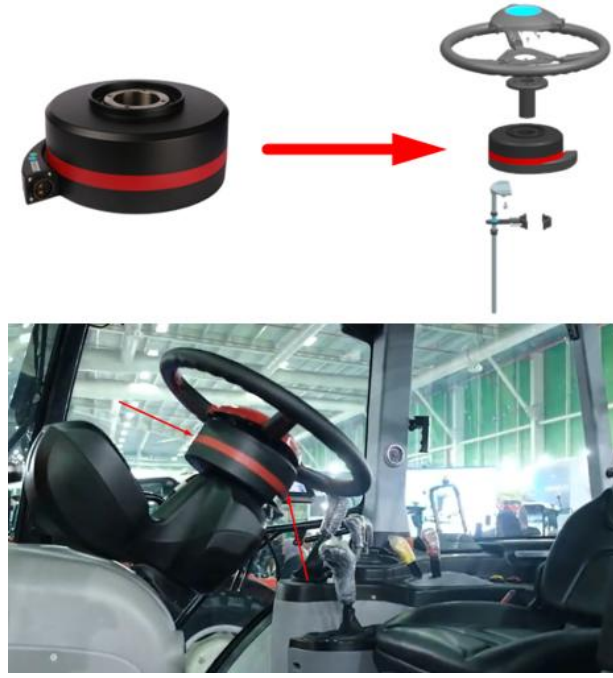
Şekil 8: Direksiyon Mekanizmasının Montajı
