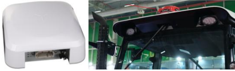
Şekil 6: R70 GNSS Alıcısının Traktör Üzerindeki Konumu
