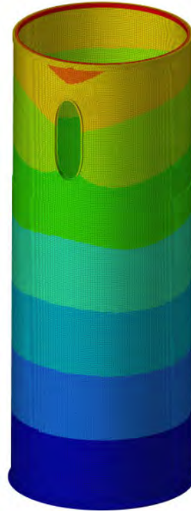
Şekil 6. HyperWorks programında statik analiz işlemi gerçekleştirilen kule alt bölümü (Tower Transition Section) yer değiştirme (Displacement) değerleri.
