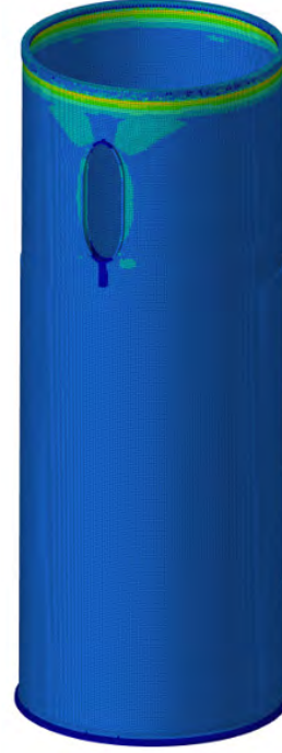
Şekil 5. HyperWorks programında statik analiz işlemi gerçekleştirilen kule alt bölümü (Tower Transition Section) Von Mises stress değerleri.
