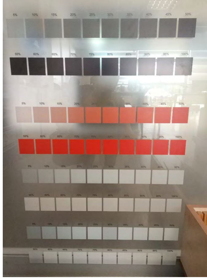
Şekil 7. Dijital Baskı Opaklık-Transparanlık Yapılabilirliğini Görmek İçin Basılan Deneme Camı
