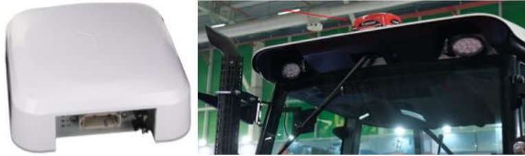
Şekil 6: R70 GNSS Alıcısının Traktör Üzerindeki Konumu
